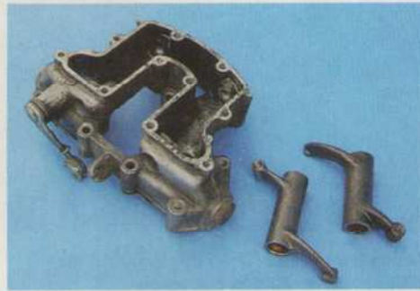
Und noch ein Verschleißkandidat: Die Kipphebel leiden ebenfalls oft unter Pitting
