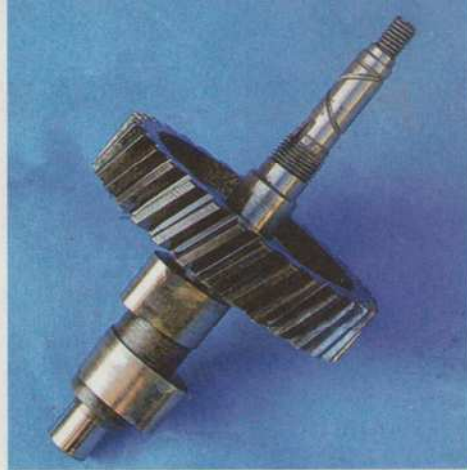
Weniger hart betroffen als die Stößelbecher: die Nockenwelle des ohv-Einzyglinders
