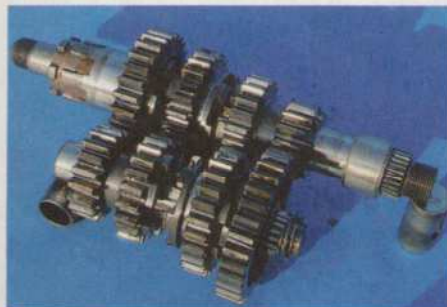
Solide konstruiert: Das Vierganggetriebe gibt nur selten Anlass zur Sorge
