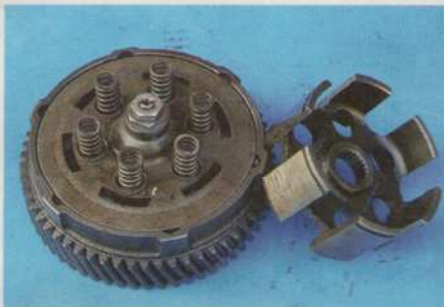
Normaler Verschleiß: Innerer und äußerer Kupplungskorb neigen zur Riefenbildung
