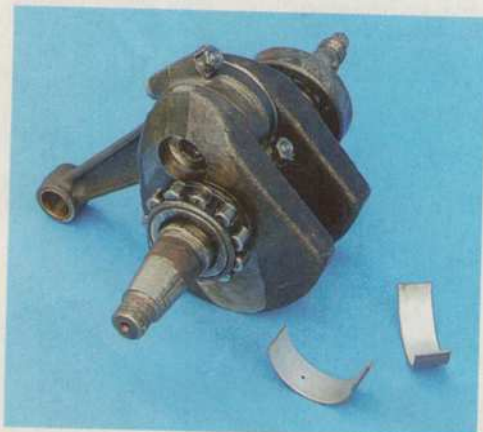
Erzsolide: der Kurbeltrieb. Laufleistungen von 100.000 Kilometern sind überliefert!
