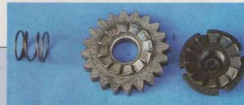
Mitunter verschlissen: Die Stirnverzahnung des Kickstarterfreilaufs
