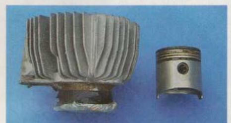
Kein Thema: Kolben und Zylinder sind langlebig, Übermaßkolben problemlos lieferbar
