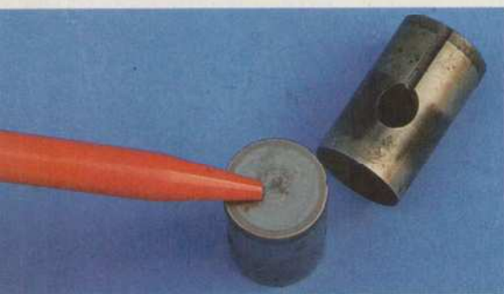
Unnötig schwere Ventile, knallharte Ventilfedern, wenig Öl – Pitting ist die Folge
