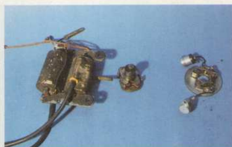
...bei der die Guzzi-Ingenieure wieder auf Kontaktzündung mit Fliehkraftverstellung setzten
