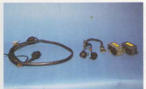
Die ursprünglich verbaute elektronische Zündung hatte sich als nicht sehr zuverlässig erwiesen
