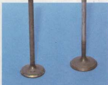
Wackelkandidat: Die Auslassventile reißen schon gerne mal ab!
