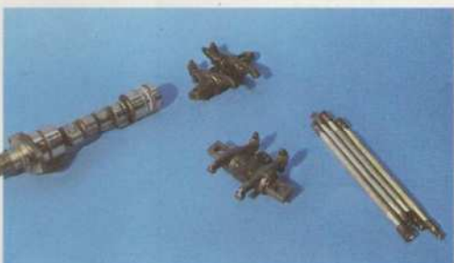
Klassische ohv-Lösung: untenliegende Nockenwelle mit Kettenantrieb, lange Stößelstangen und Kipphebel
